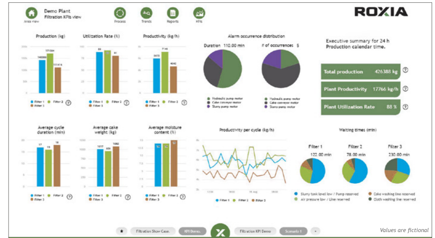
Tärkeimmät suorituskykymittarit (KPI) on kerätty kaikki yhteen näkymään, jolloin suodatusprosessin tilanteen näkee yhdellä silmäyksellä.
