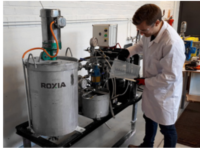
Painesuodattimen testiyksikkö simuloi normaalikokoisen teollisen suodattimen toimintaa.
