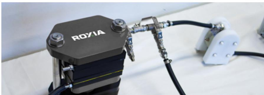
La unidad de prueba de filtro prensa simula el funcionamiento del filtro industrial de tamaño complete.
