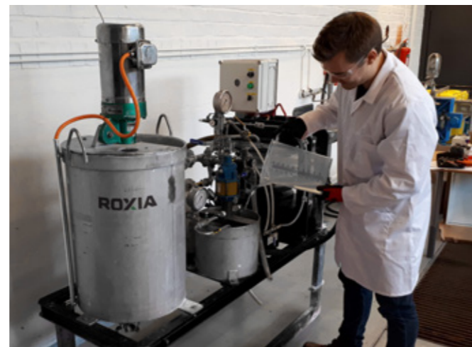
Тестовая установка башенного пресс-фильтра имитирует работу полноразмерного промышленного фильтра.
