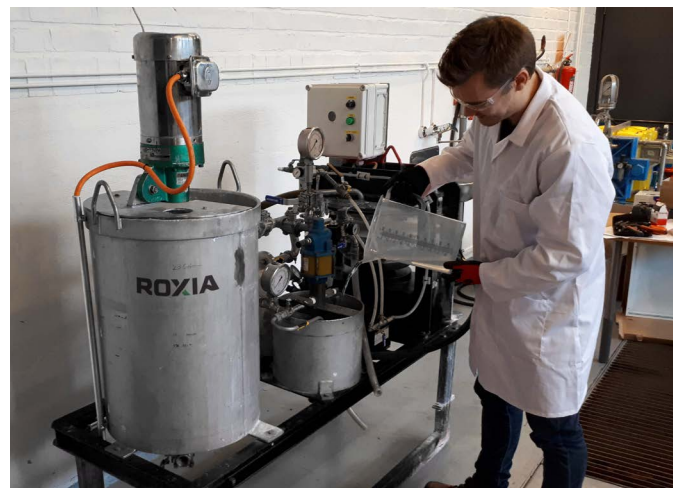
La unidad de prueba del filtro prensa tipo torre simula el funcionamiento del filtro industrial de tamaño completo.
