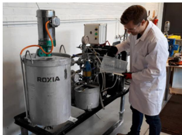
Das Vertikalpressen-Testgerät simuliert den Betrieb großer Industriefilter.
