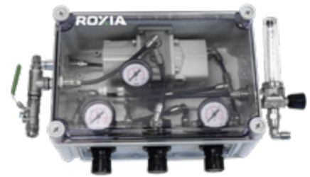
La unidad completa de prueba encaja en un maletín, lo que hace que sea más fácil y rápido probar la pulpa in situ.
