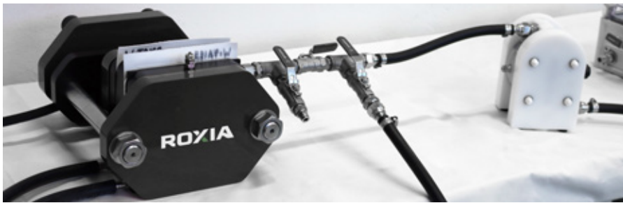
La unidad de prueba de filtro prensa simula el funcionamiento del filtro industrial de tamaño completo.
